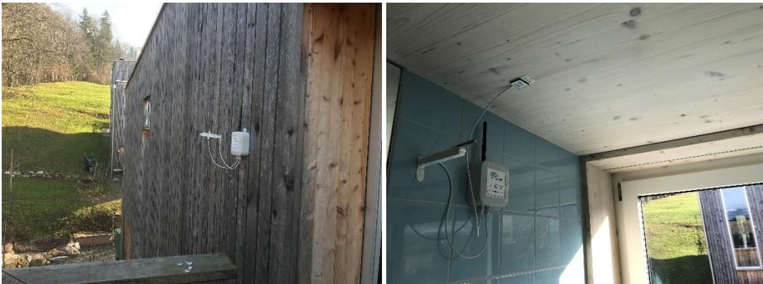
Abbildung 2 Aussenmessknoten c800016, Typ 2 (links) und innenmessknoten c800007, Typ 1 (rechts)
