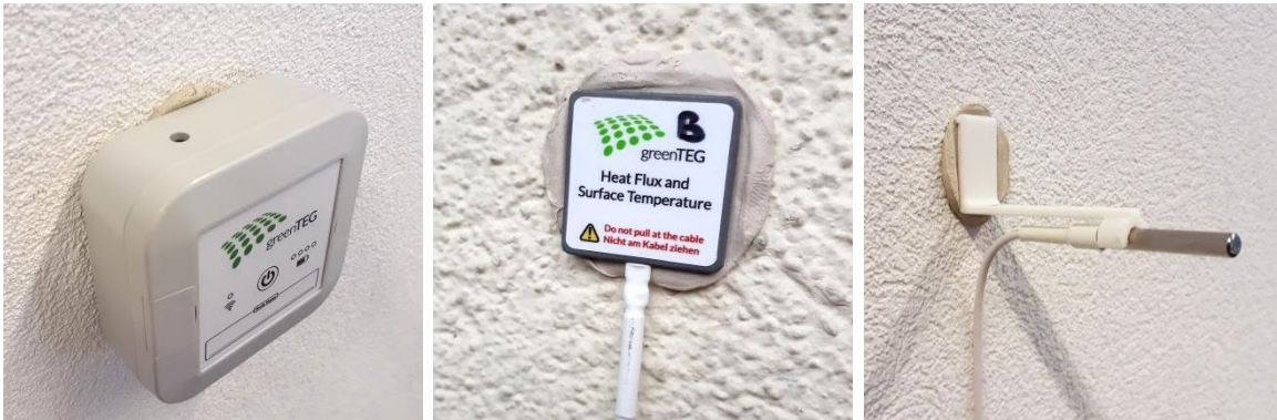
Bild 2: Mit Knetmasse montiertes gOMS-System. Links: Node (hier ohne Antenne zur Ansicht); Mitte: Oberflächensensor; Rechts: Umgebungstemperatursensor.
