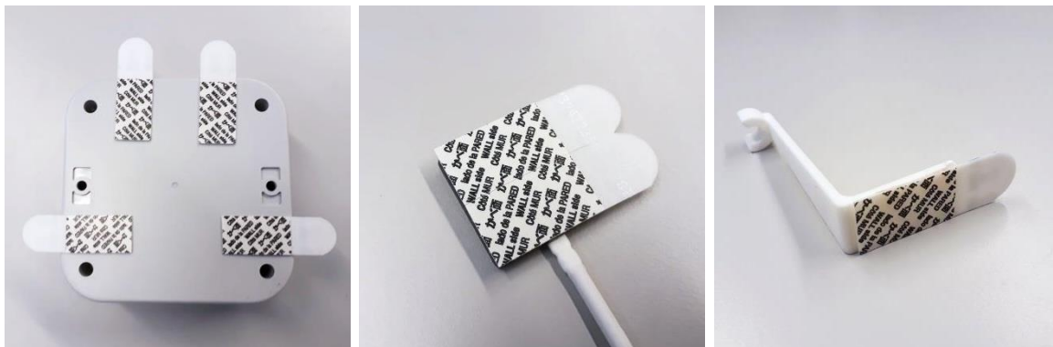
Bild 5: Empfohlene Anbringung der Montagestreifen an Node (links), Oberflächensensor (Mitte) und Umgebungssensor(rechts).
